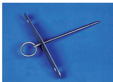
8. attēls. Kontroles adata, domāta dūruma vietas un leņķa pārbaudei.
