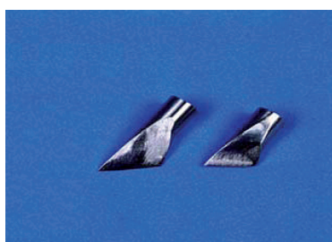
7. attēls. PG 200 iekārtas zondes asmens: kreisajā pusē – atbilstošs, labajā – stipri nolietots.
